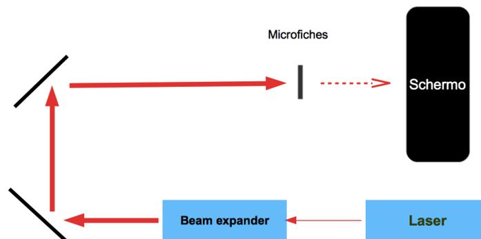
Il setup con cui osservare questi pattern di diffrazione è composto da un laser He-Ne (Elio-Neon) che fornisce una luce a lunghezza d'onda di circa 633nm. Questa attraversa un beam expander il cui scopo è quello di allargare leggermente il fascio. Due specchi la dirigono quindi verso le microfiches e il pattern risultante è osservato su uno schermo.
